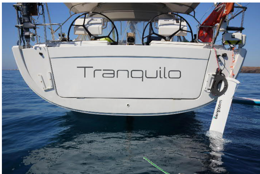
Ein Watt&Sea – zwei Einschubhalterungen – je nach Lage umzusetzen.
