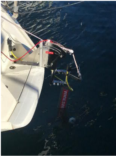
Der ausgesprochen stabil gebaute Swi-Tec Hydrocharger auf dem Scoop einer Yacht montiert. Gut verdeutlicht, wie er eingeholt und ausgesetzt wird.
