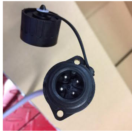
Die Verbindung zum Bordnetz muss mit Sorgfalt erfolgen. Korrosion kann die gelieferte Spannung reduzieren oder ganz zum Erliegen bringen.
