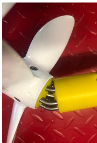
Die interessante Umlenkung der Propellerwelle.
