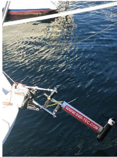
Der ausgesprochen stabil gebaute Swi-Tec Hydrocharger auf dem Scoop einer Yacht montiert. Gut verdeutlicht, wie er eingeholt und ausgesetzt wird.
