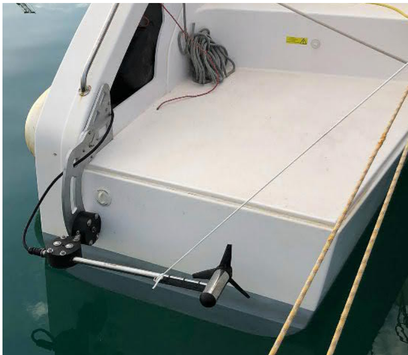
Der SailINSea SailingGen von Prof. Armin Horn montiert an dem Ausleger eines Katamarans.
