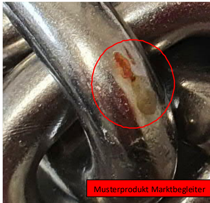
Bild 9: beginnender Rotrost an Riefe 10x28mm bereits nach 24h in der Salzsprühnebelkammer
