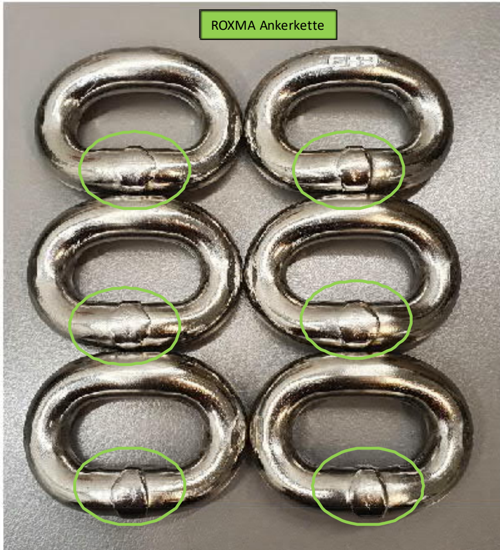
Bild 7: ROXMA Kettenglied -10x28 mm- nach Biegeversuch
