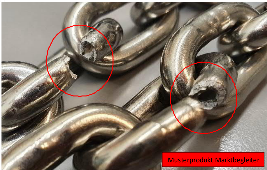
Bild 2: 8x24 mm Schweißnahtbrüche beim Zugversuch
