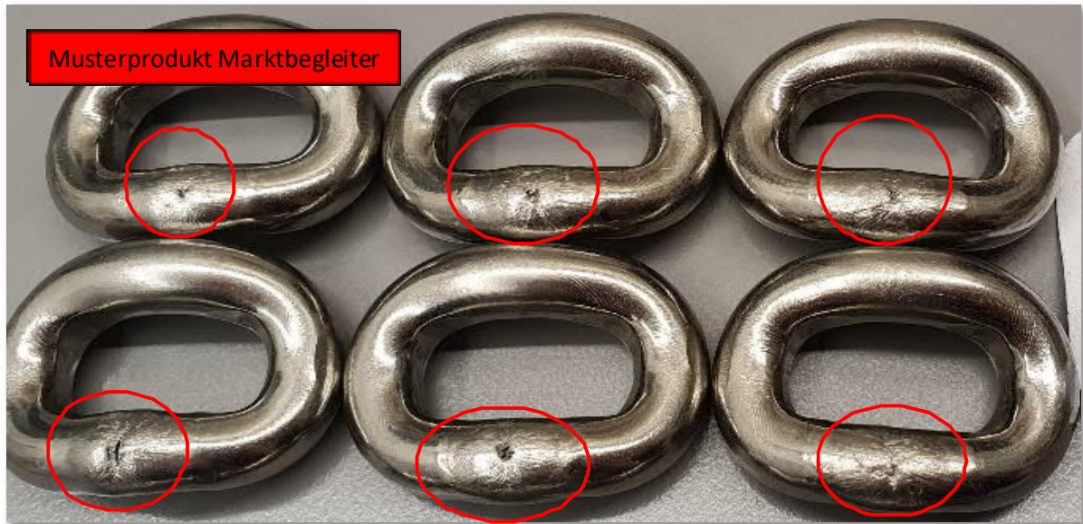
Bild 6: Musterprodukt Marktbegleiter -10x28 mm- nach Biegeversuch
