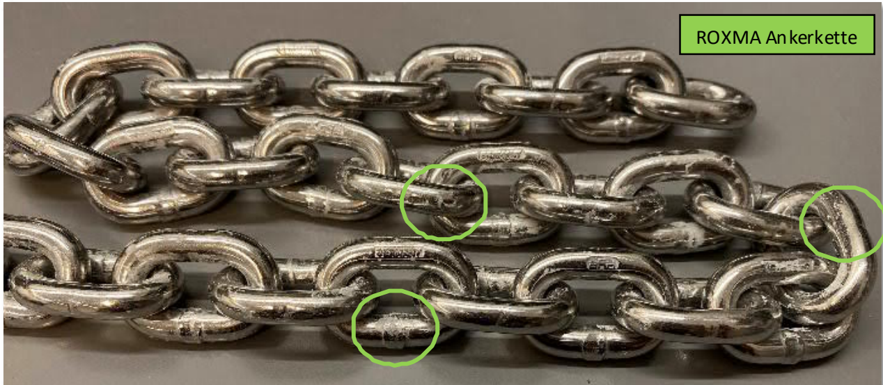
Bild 10: ROXMA Kette 8x24 keine Anzeichen von Korrosion nach 2.500h in der Salzsprühnebelkammer
