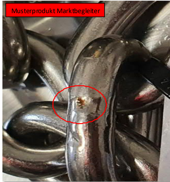
Bild 8: beginnender Rotrost an Schweißnahtschwachstelle 8x24mm bereits nach 24h in der Salzsprühnebelkammer
