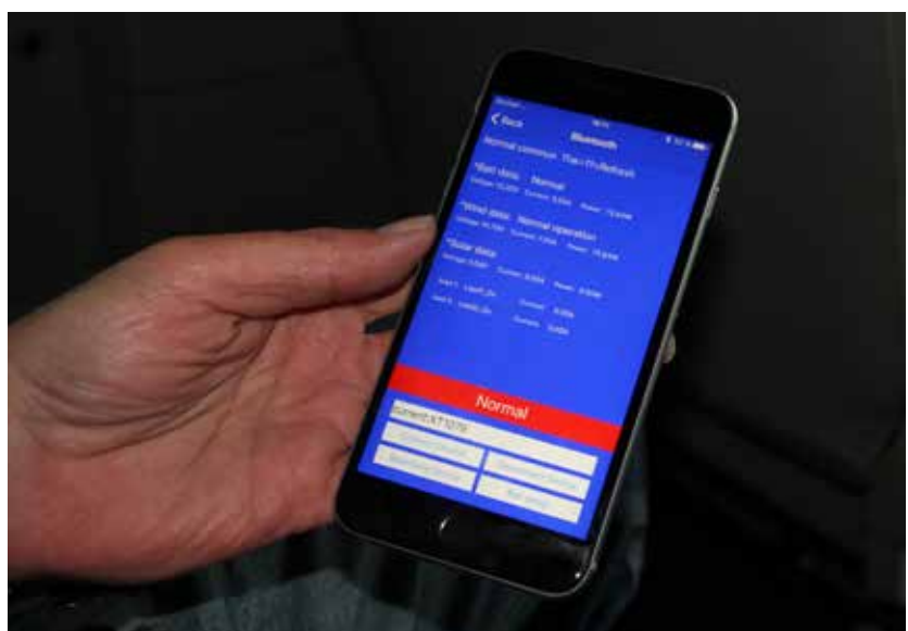
Mitteilungsfreudig: Der Regler des Silentwind sendet seine Leistungsdaten per Bluetooth auf Smartphones mit Android oder IOS.
