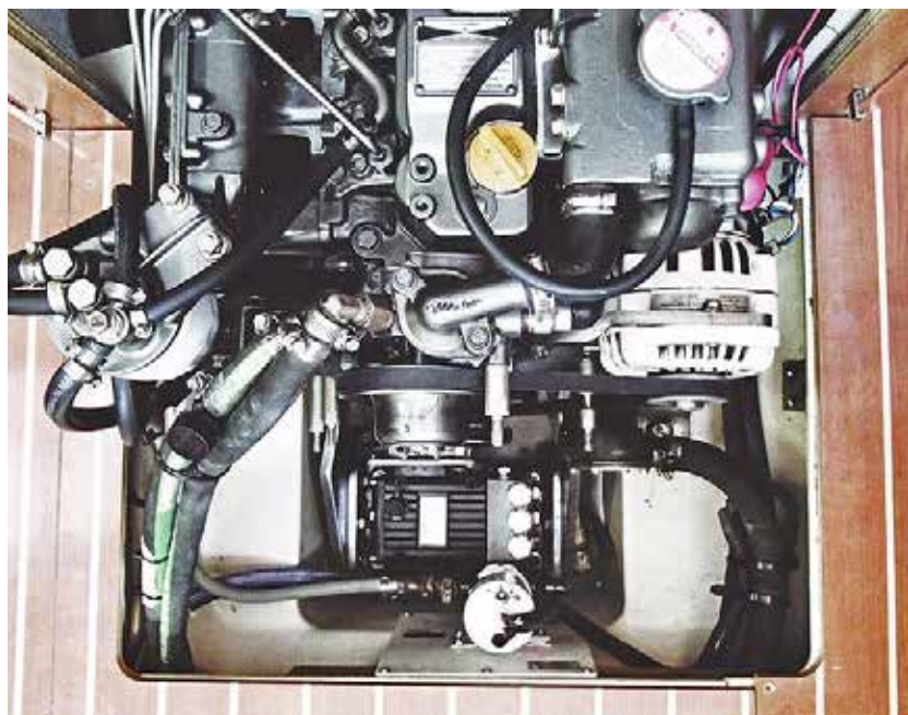
Eine andere Montagemöglichkeit: Echotec, diesmal unter dem Motor.
