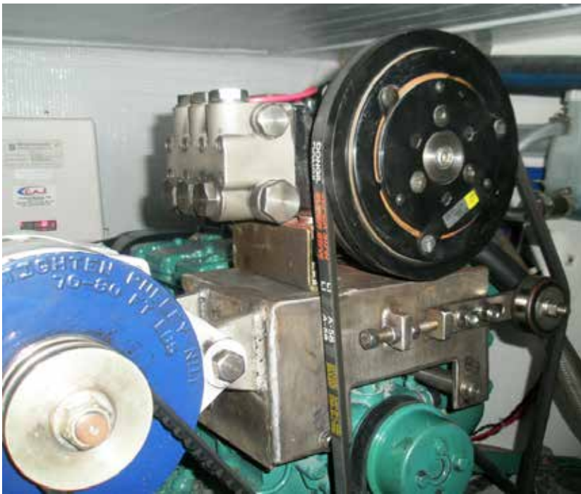
Die Hochdruckpumpe einer Echotec oben auf dem Motorblock montiert.
