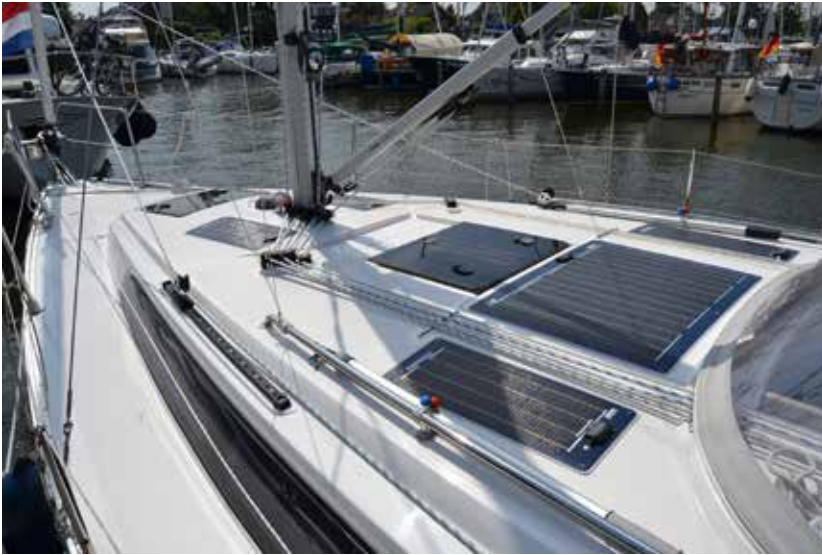
Maximale Ausbeute: Unterschiedliche Größen erlauben die Nutzung des Aufbaus, aber – wie erkennbar – mit den Nachteilen der Abschattungen.
