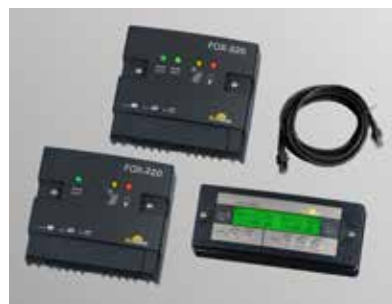
PWM (Pulsweiten-modulierter) Regler: Gesteuerte Unterbrechung der Ladung zur Vermeidung von Überladung.
