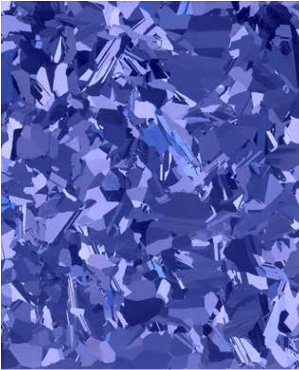
Links: Polykristalline Oberfläche, die während des Erkalts nach dem Einschmelzen entsteht. Leistungsgrad bis 16 Prozent.
