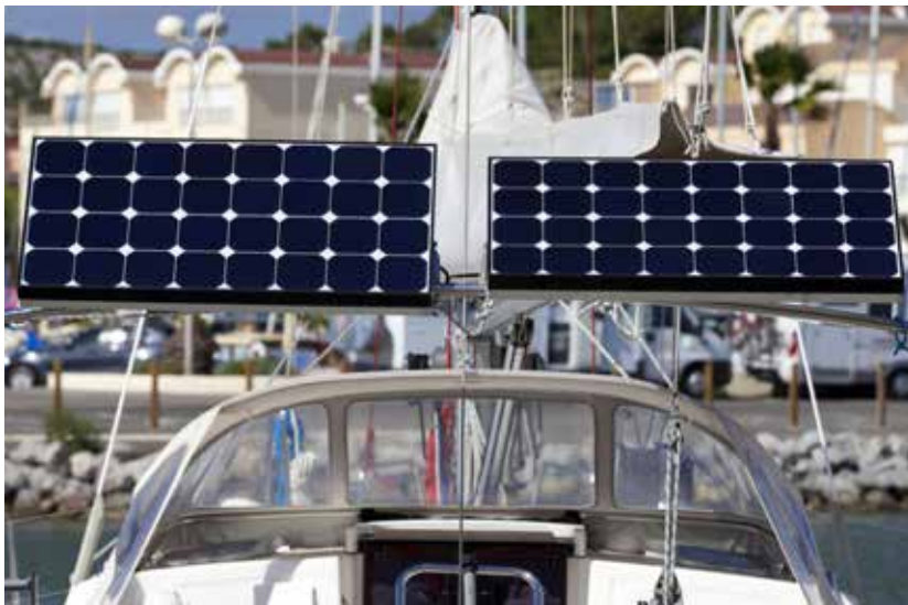
Leistungsfähige monokristalline Panele am Heck einer Fahrtenyacht: Mit 22 bis 24 Prozent Ausbeute heute State of the Art. Nachteil: Bruchgefährdet, eigentlich für die feste Montage an Land gedacht.
