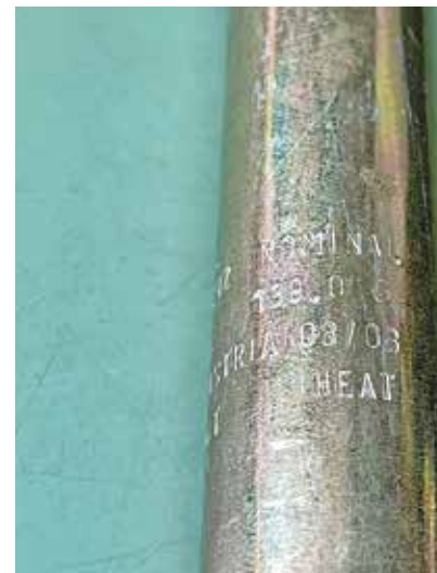
Auf einer CO 2 -Patrone sind die Daten zur Herstellung, Füllmenge und Bruttogewicht zu finden.
