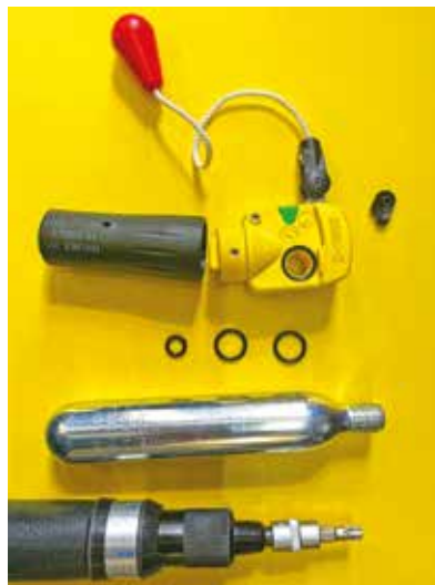
Ein UML-Automat und die benötigten Werkzeuge und Ersatzteile, um eine Rettungsweste zu warten.
