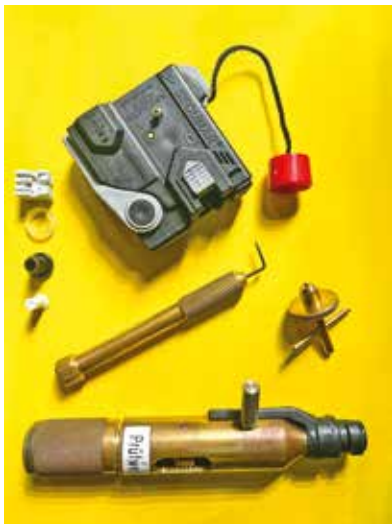
Die zur Wartung eines Secumar-4001-Automaten notwendigen Werkzeuge und Teile.
