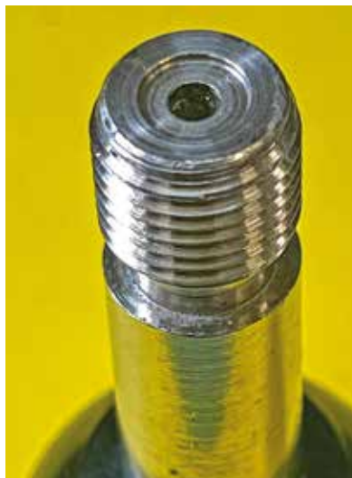
Diese Prüfvorrichtung wird anstelle der CO 2 -Patrone mit einem Prüfplättchen versehen und eingeschraubt.
