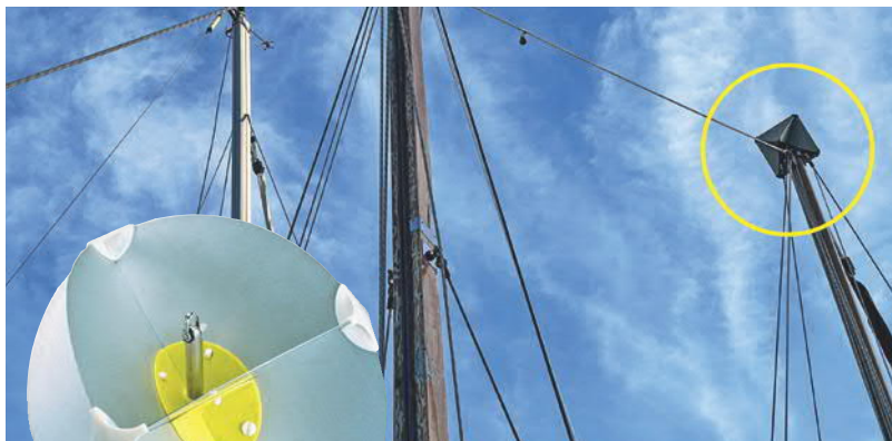
Oben: Ein fester Oktaeder-Radarreflektor in Regenfangstellung auf dem Besantopp. Links: Der Trem-Oktaeder (MED-Radarreflektor) ist zum Vorheizen in Regenfangstellung konzipiert.
