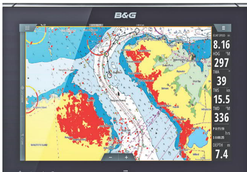
Overlay: Das Radarbild ist in Rot über die Seekarte gelegt.
