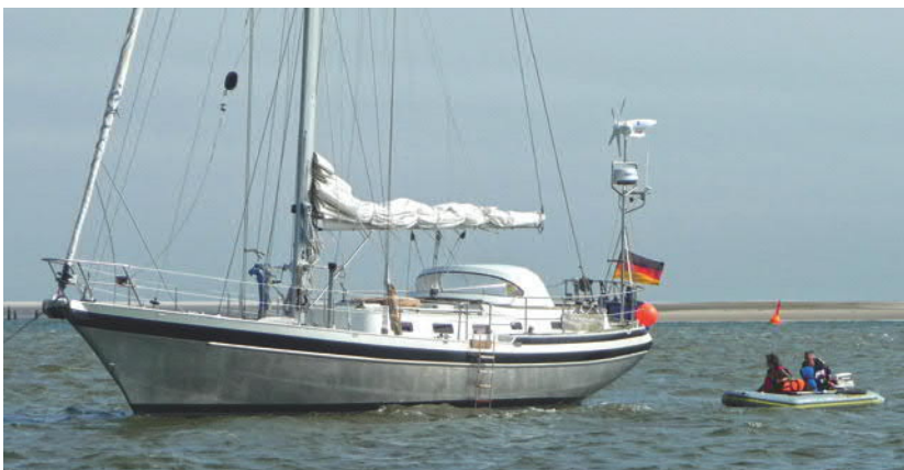
Geräteträger mit Antennen, Signalhorn, Windgenerator und Radar.
