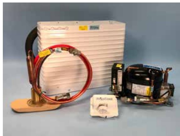
Eine wassergekühlte Anlage mit Außenbord-Wärmetauscher. Hier muss ein Loch in den Rumpf, der Durchgang besteht aber aus Sintermetall und sehr stabil.
