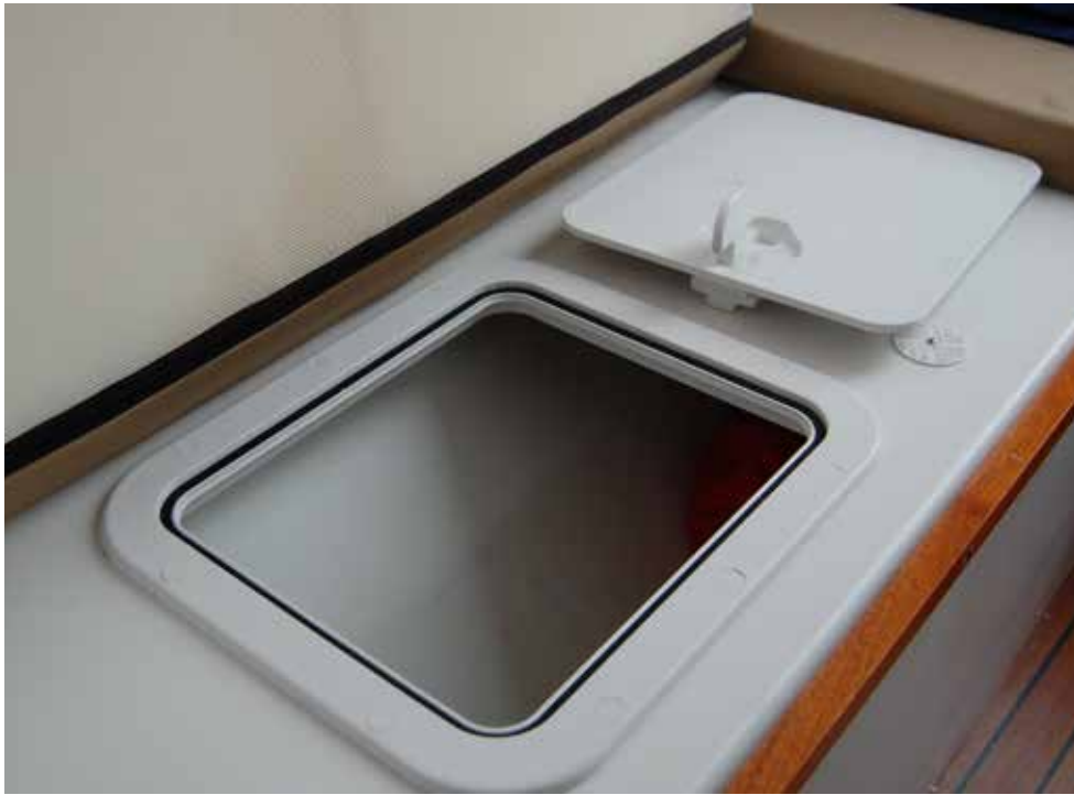
Kühlfach auf einer Serienyacht. Gut gemacht: Das Dichtgummi verhindert das Flüssigkeit ins Fach läuft!
