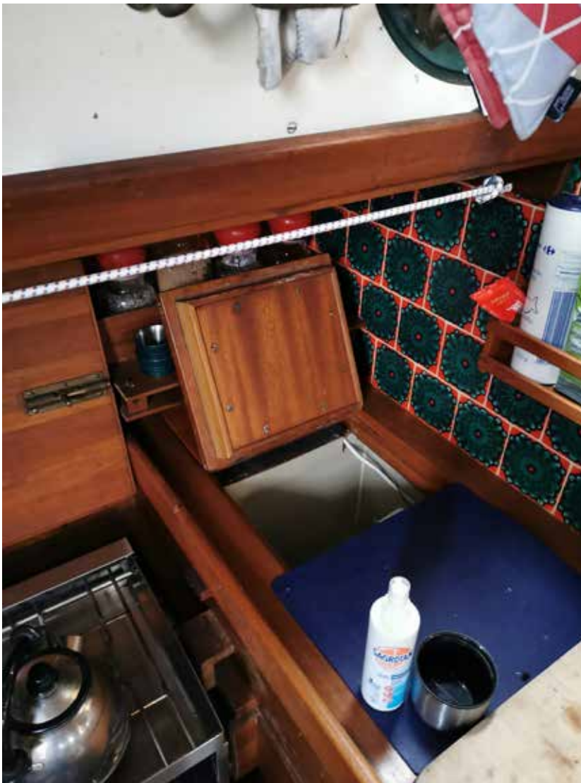
Ein Kühlfach im Selbstbau auf einer 70er-Jahre Yacht.
