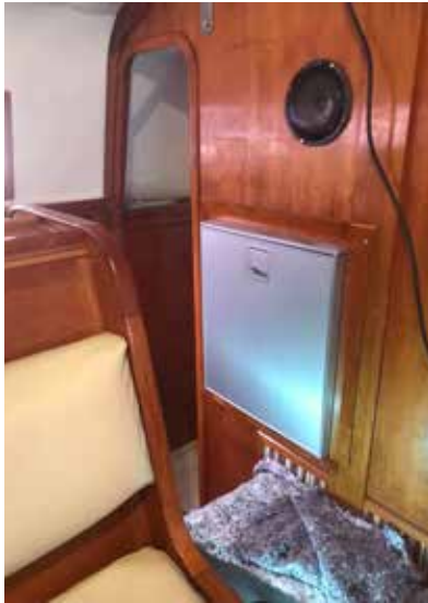
Diese Kühlschublade wurde in die Wand zum dahinter liegenden Schrank eingesetzt.
