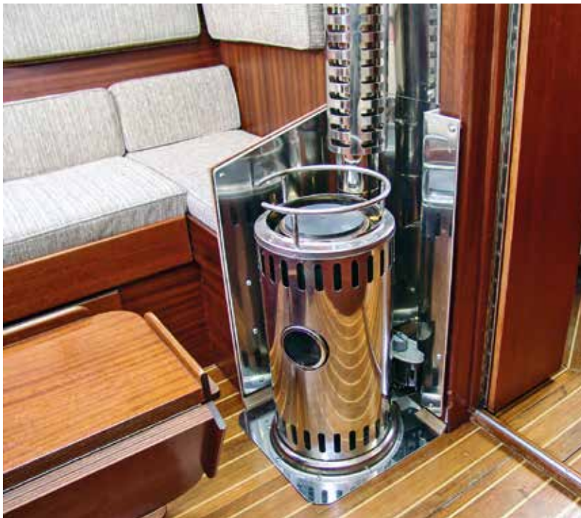
Ein dänischer Reflekt-Diesellofen mit Wärmeschutzblechen. Es gibt sowohl kleinere als auch größere Modelle.
