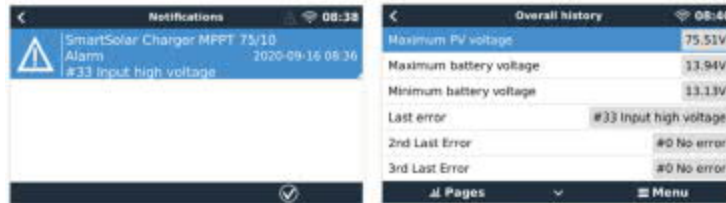
GX-Gerät mit Warnmeldeanzeige und historischen Fehlern.
