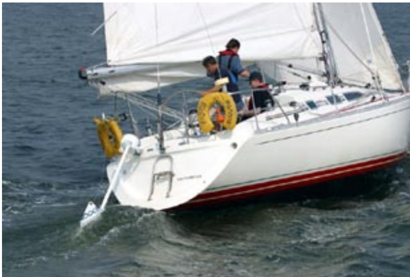
Der DuogenII fühlt sich im Wind und im Wasser wohl. Als Schleppgenerator bringt er bei fünf Knoten Fahrt sechs Ampere Ladestrom (kein Testwert)
